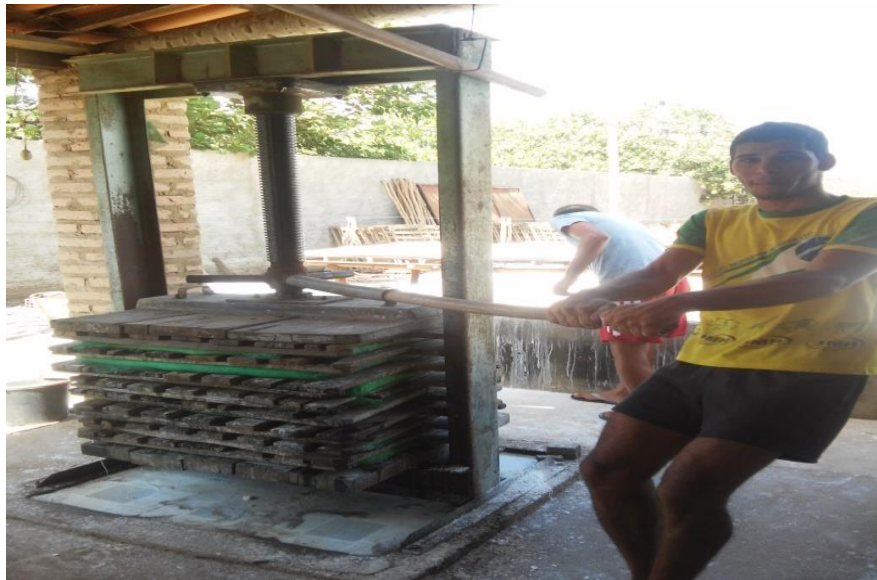
Figura 7: Massa sendo imprensada, na farinhada do Sr. José da Silva Carvalho
