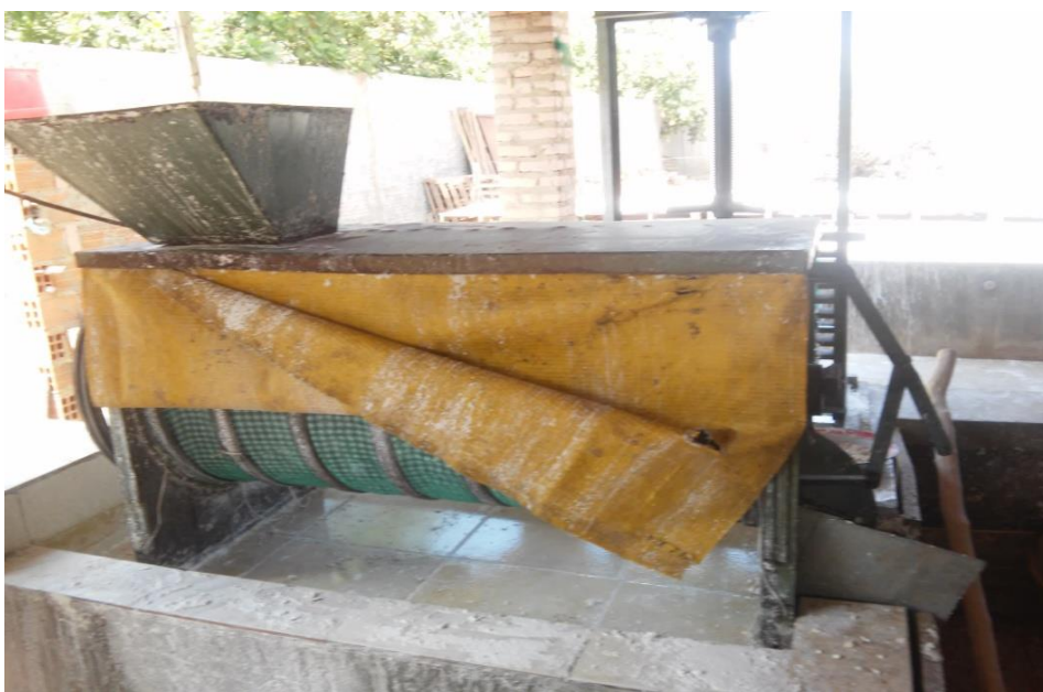
Figura 9: Máquina de lavar elétrica, da casa de farinha do Sr. José da Silva Carvalho
