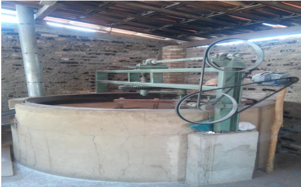
Figura 8: Forno elétrico da casa de farinha do Sr. José da Silva Carvalho
