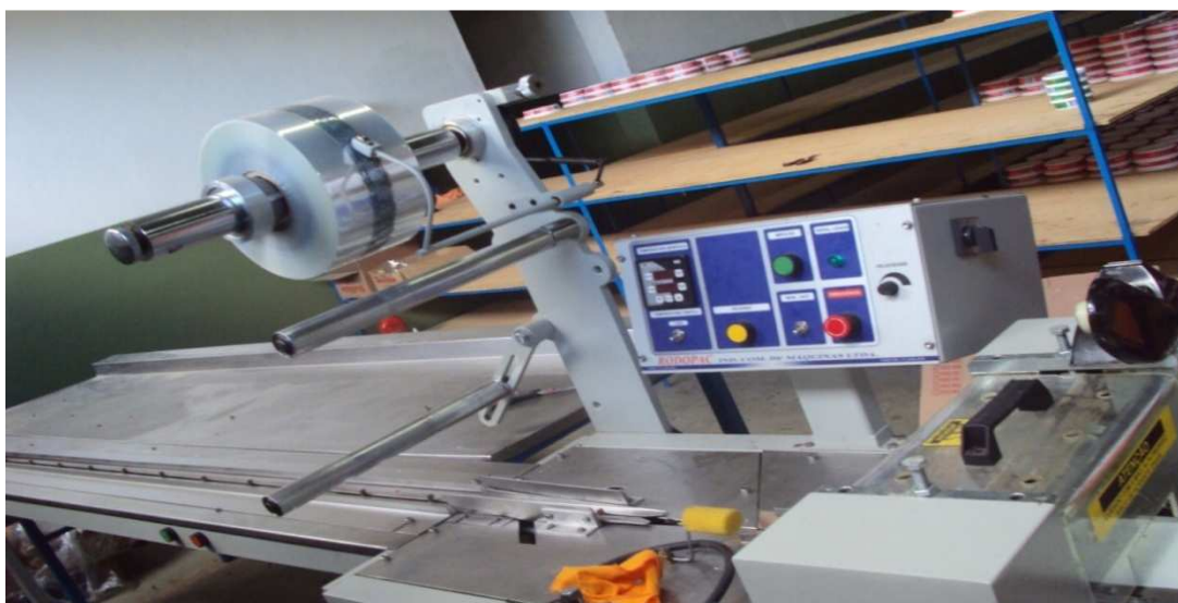
Figura 2 – Máquina embaladora dos doces de barras pequenos
