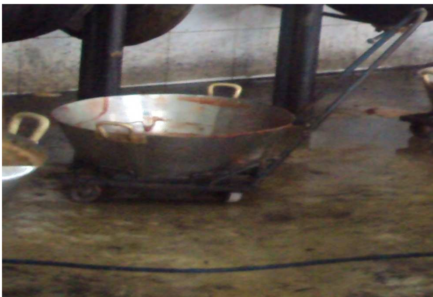
Figura 8 – Tacho para transportar bananas ou goiabadas despolpadas
