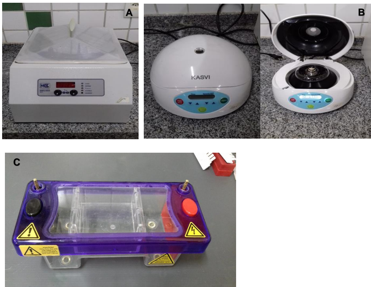
Figura 13 – Equipamentos utilizados na extração do DNA dos tecidos. A: Banho Maria; B: Centrífuga; C: Tanque de eletroforese em gel MultiSUB Midi.
